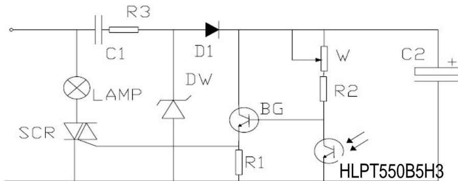
上图为光控路灯电路，白天路灯熄灭，夜间路灯自动点亮。图中，电容 C1、C2、R3 和二极管 D1 及稳压管 DW，组成简单的电容降压整流电路，接通电源后获得 12V 左右的直流电压。三极管 BG、环境光探测器 HLPT550B5H3 和双向可控硅等，组成光电开关电路。
