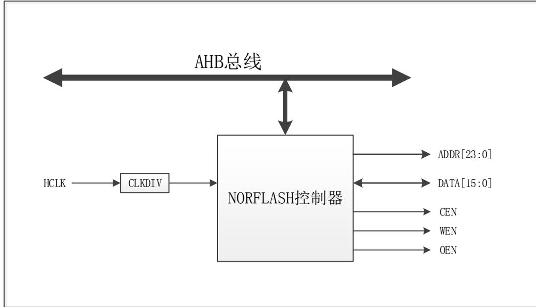
图 6-62 NORFLC 模块结构示意图
