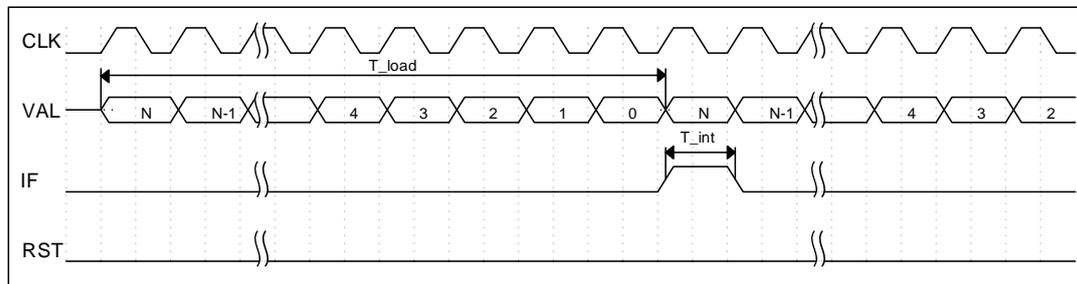
图 6-16 WDT 配置为中断模式波形图
