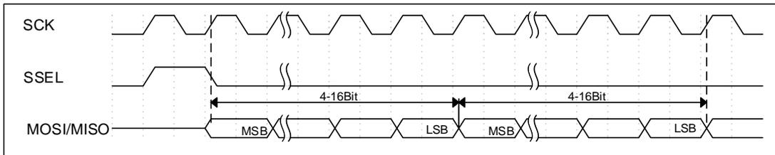
图 6-31 SSI 模式连续输出波形
