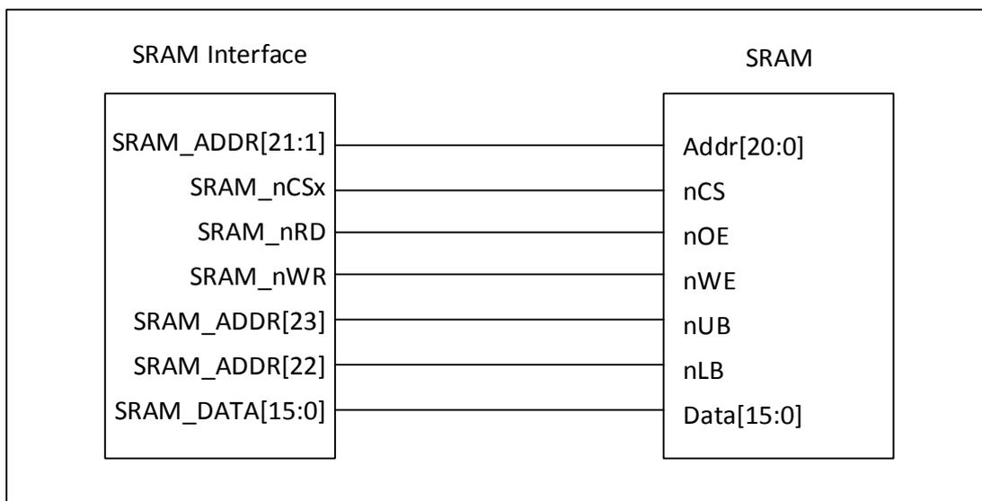
图 6-58 16-位 SRAM 数据宽度与 16-位设备连接示意图
