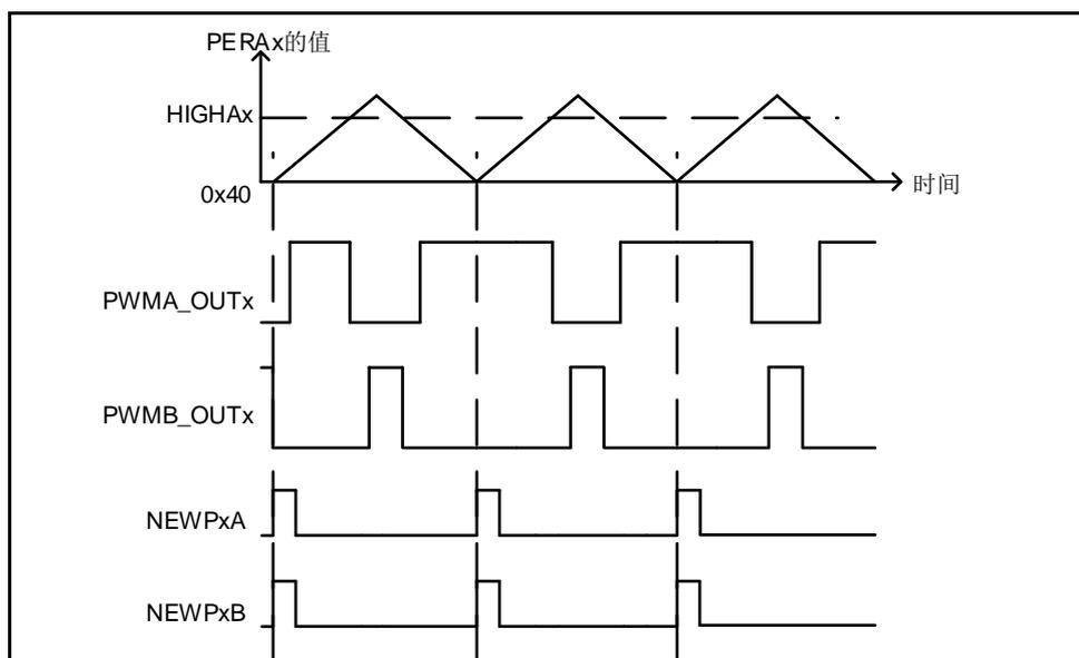
图 6-46 PWM 中心对称互补模式下新周期起始中断示意图
