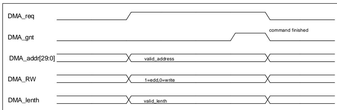
图 6-52 DMA 访问外设握手时序示意图
