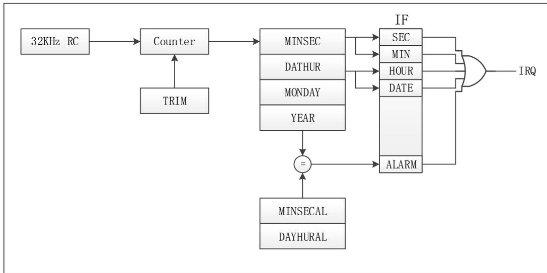
图 6-54 RTC 模块结构框图
