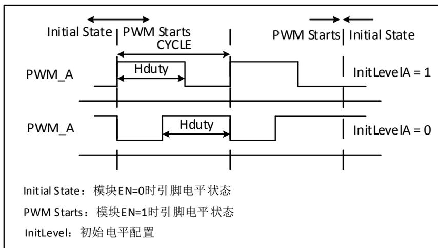
图 6-33 独立模式下初始电平配置示意图
