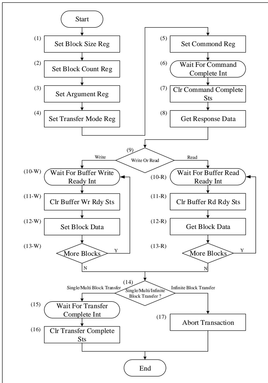
图 6-70 SDIO 不使用 DMA 传输示意图
