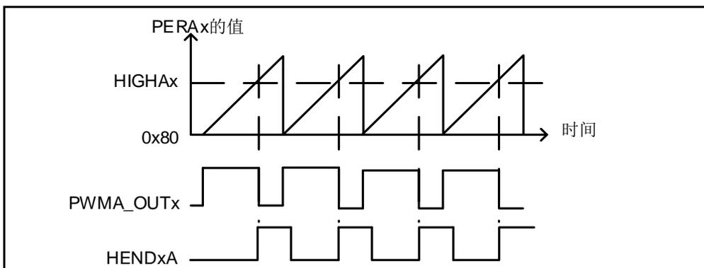
图 6-43 PWM 独立模式下高电平结束中断示意图
