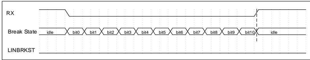
图 6-21 Break 信号恰好够长示意图
