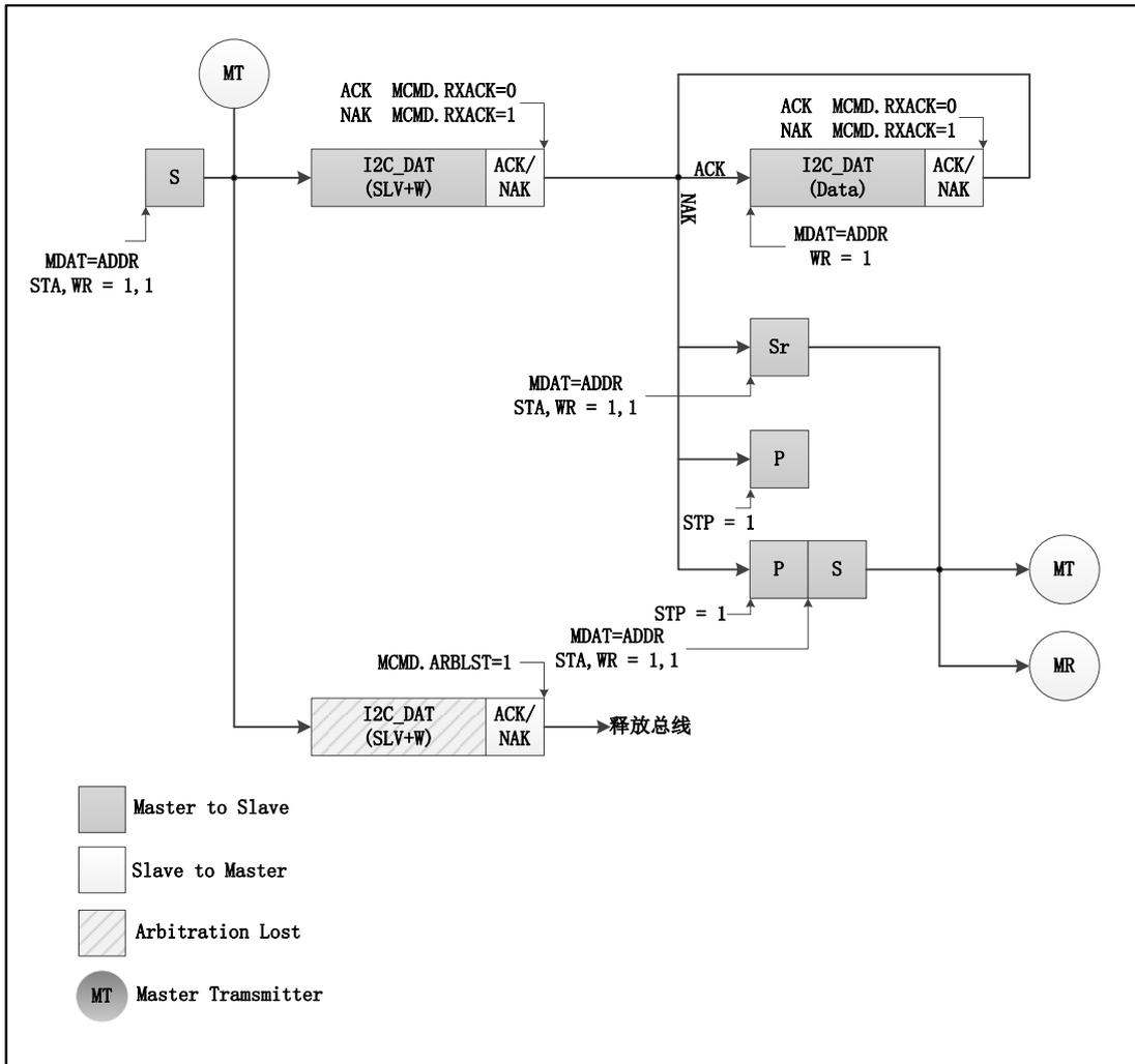
图 6-26 主机发送/从机接收流程
