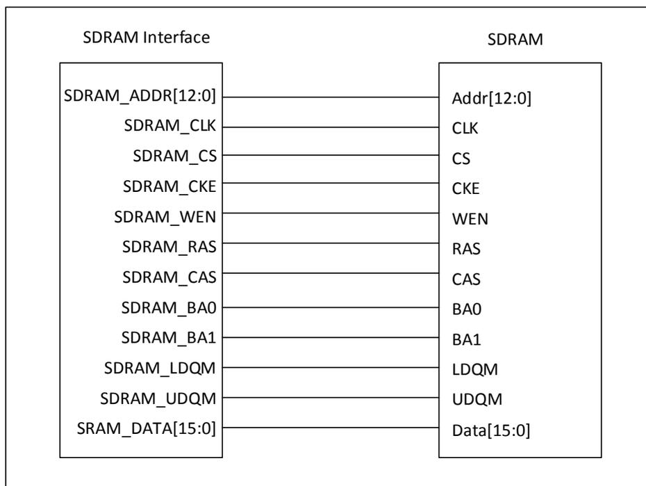
图 6-76 SDRAM 与设备连接示意图
