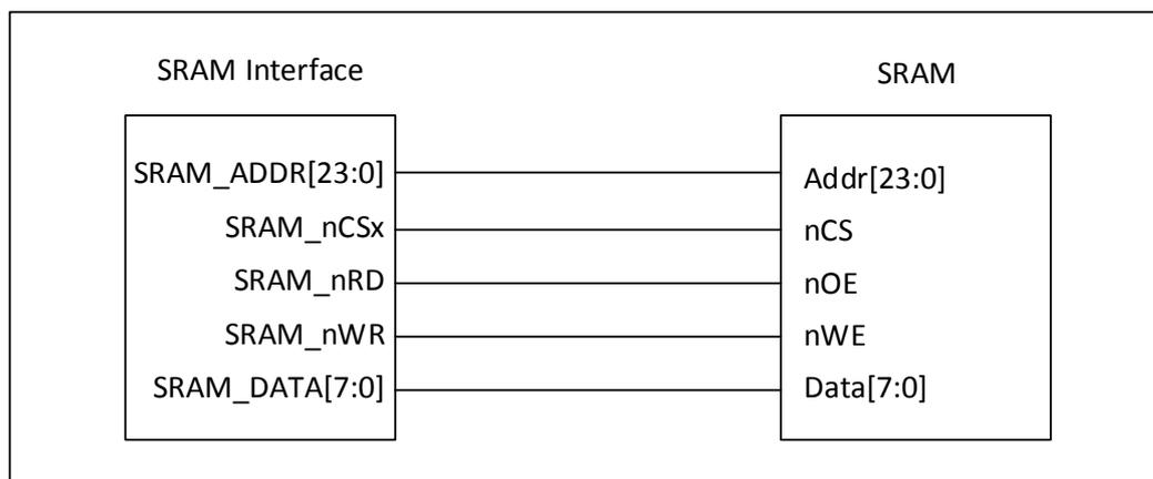
图 6-59 8-位 SRAM 数据宽度与 8-位设备连接示意图
