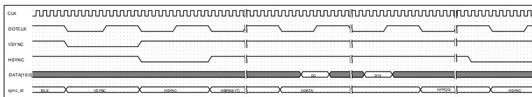
图 6-67 LCDC 模块 SYNC 接口时序图
