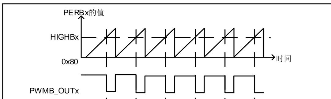
图 6-36 PWM 独立模式起始输出高电平示意图
