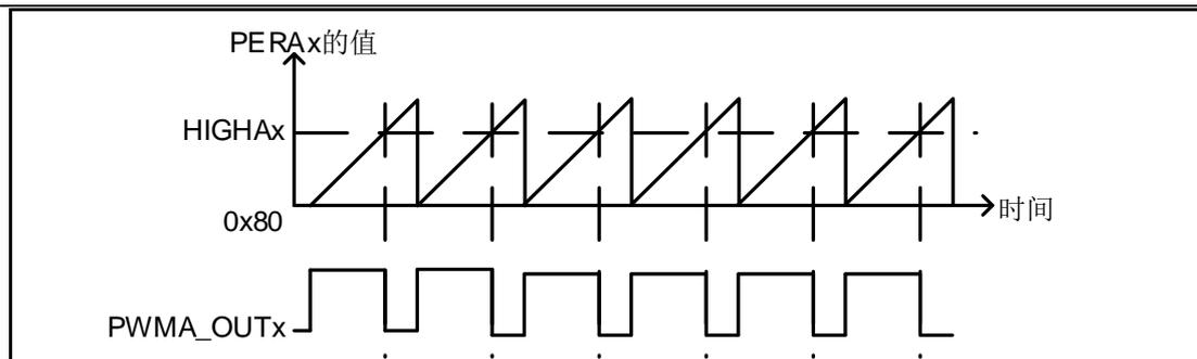
图 6-35 PWM 独立模式起始输出低电平示意图
