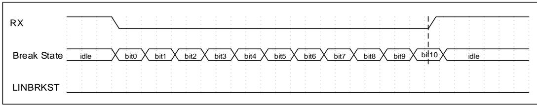
图 6-20 Break 信号不够长示意图
