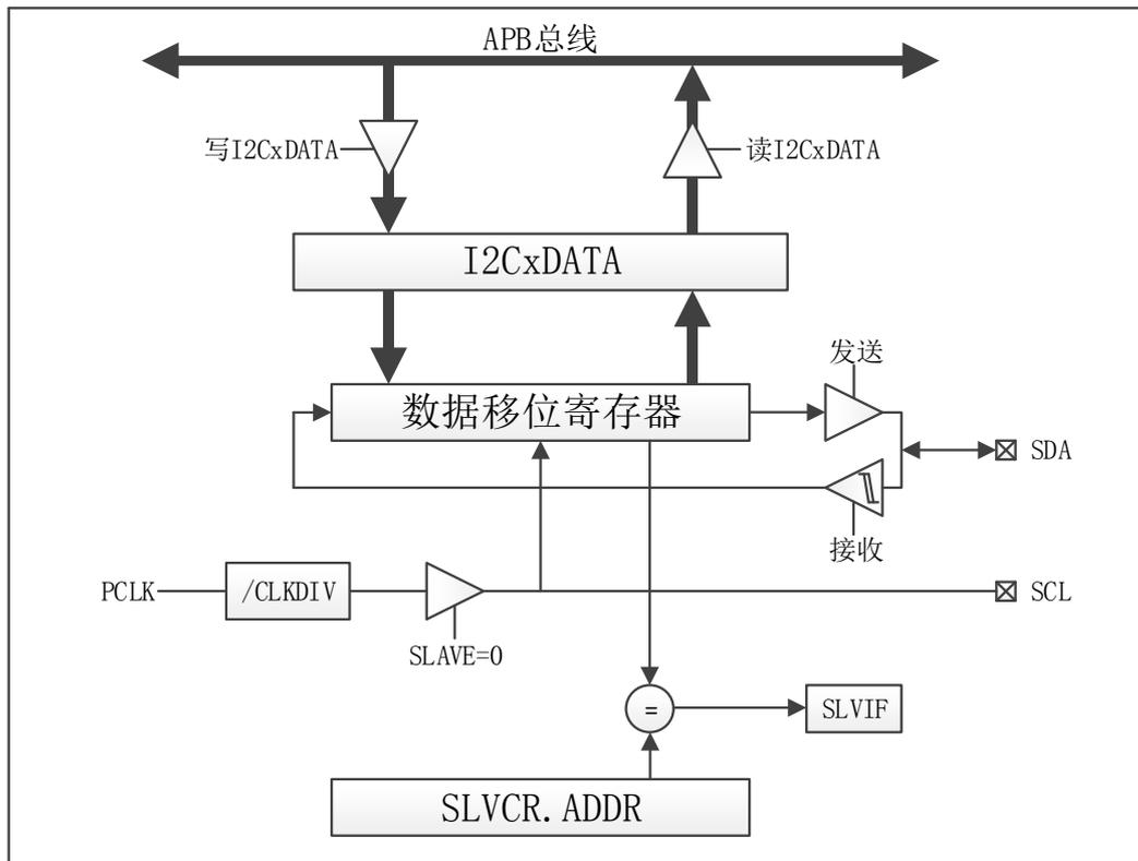
图 6-24 I2C 结构框图
