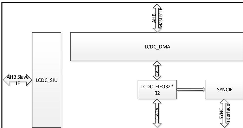
图 6-66 LCDC 模块结构示意图
