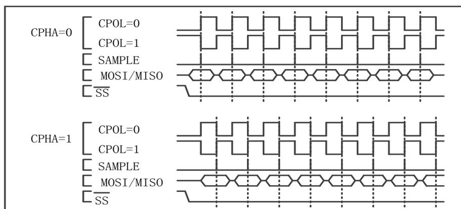
图 6-29 SPI 模式波形图
