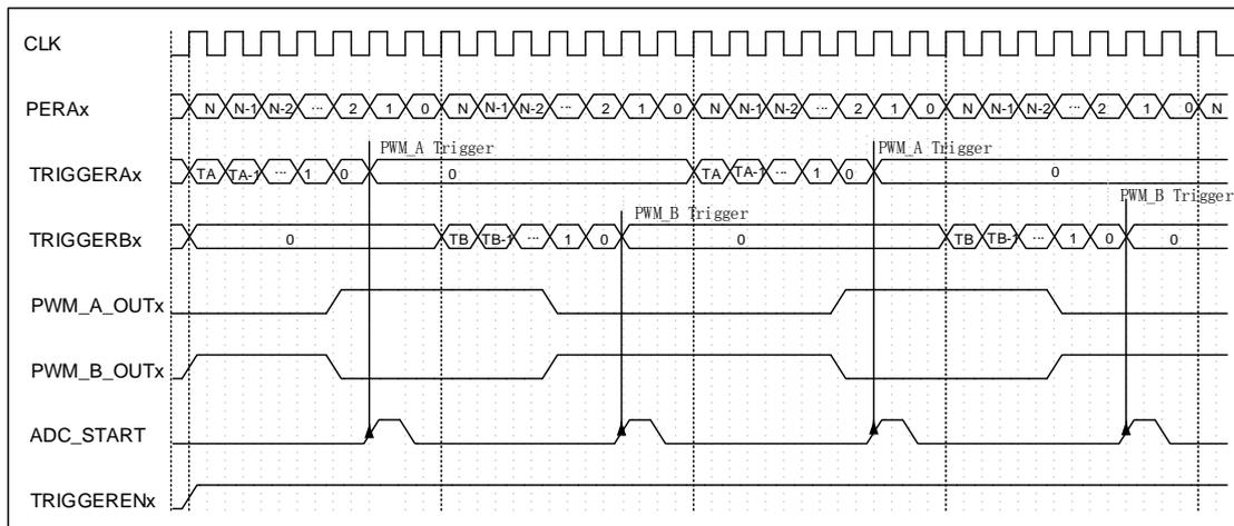
图 6-42 PWM 触发 ADC 采样示意图
