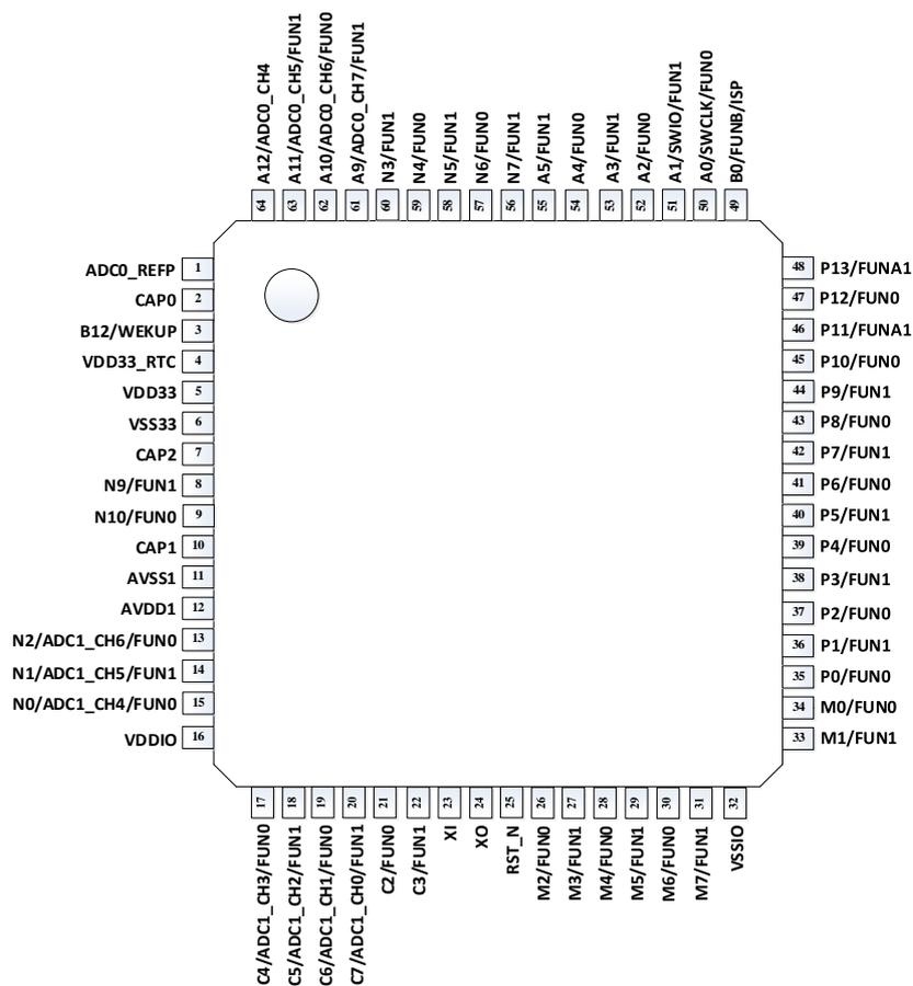
图 5-1 SWM320RET7 封装管脚配置
