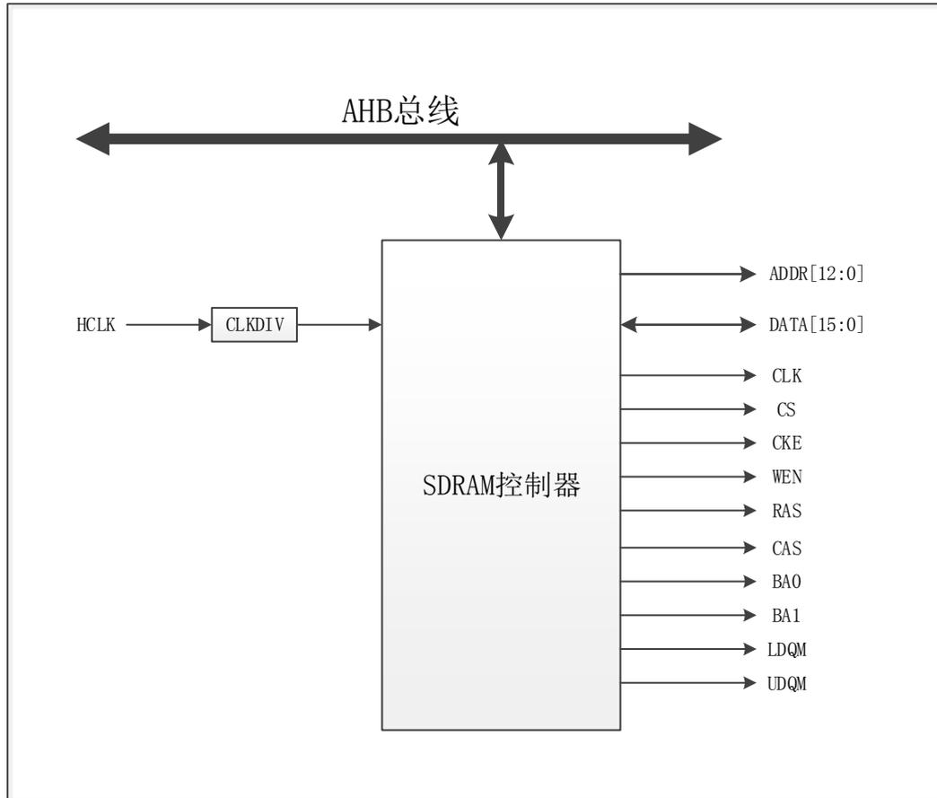
图 6-75 SDRAMC 模块结构框图
