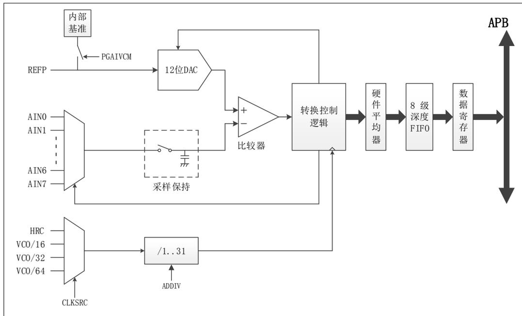
图 6-48 ADC 模块结构框图
