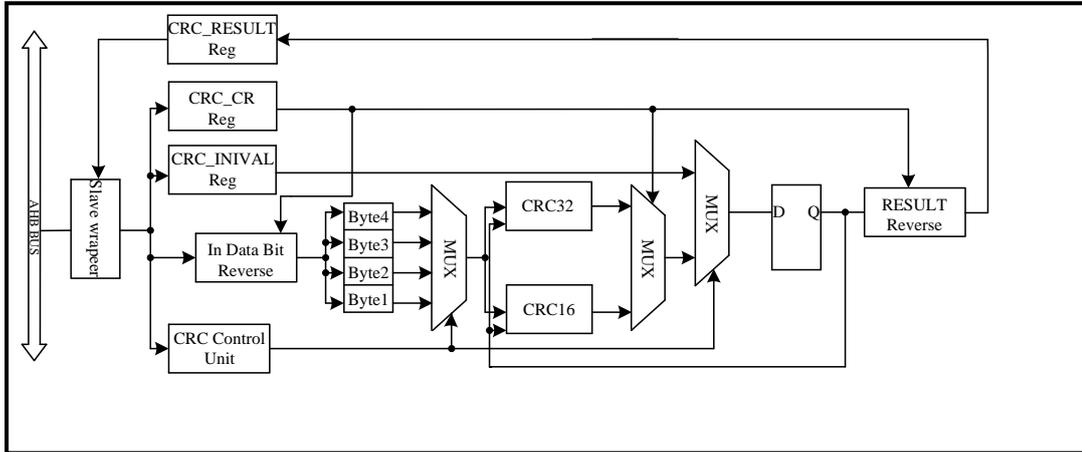
图 6-55 CRC 结构框图
