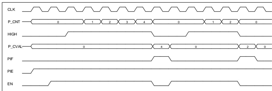
图 6-11 单次捕捉高电平脉冲
