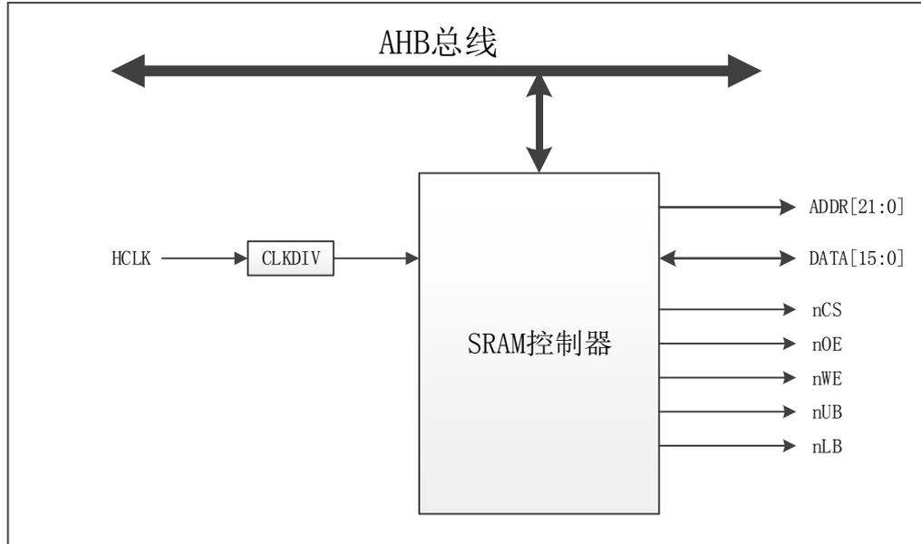
图 6-57 SRAMC 模块结构示意图
