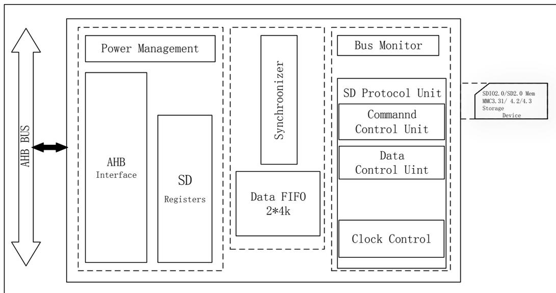
图 6-68 SDIO 模块结构框图
