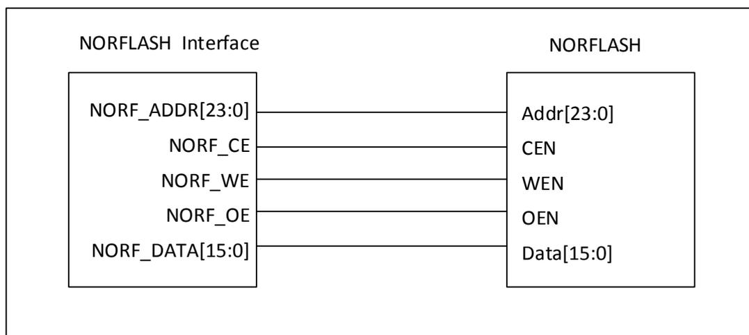
图 6-63 NORFLASH 和设备连接示意图
