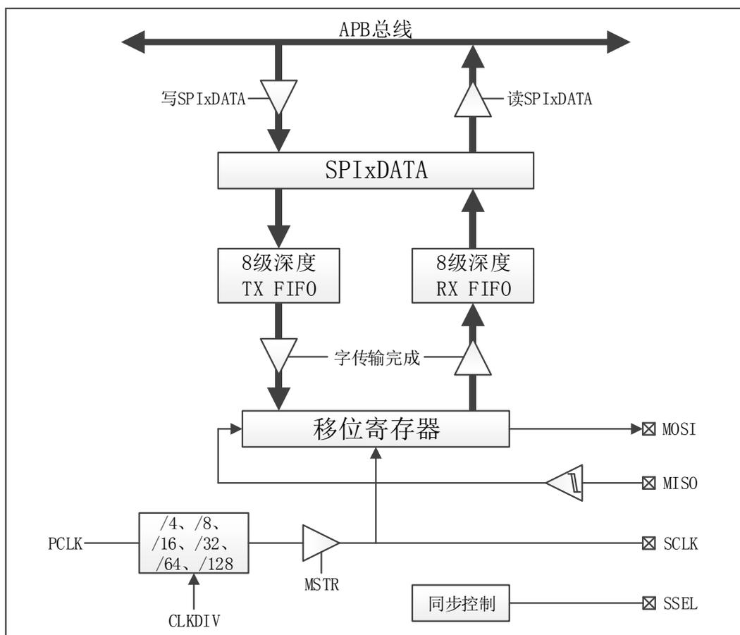
图 6-28 SPI 控制器结构示意图
