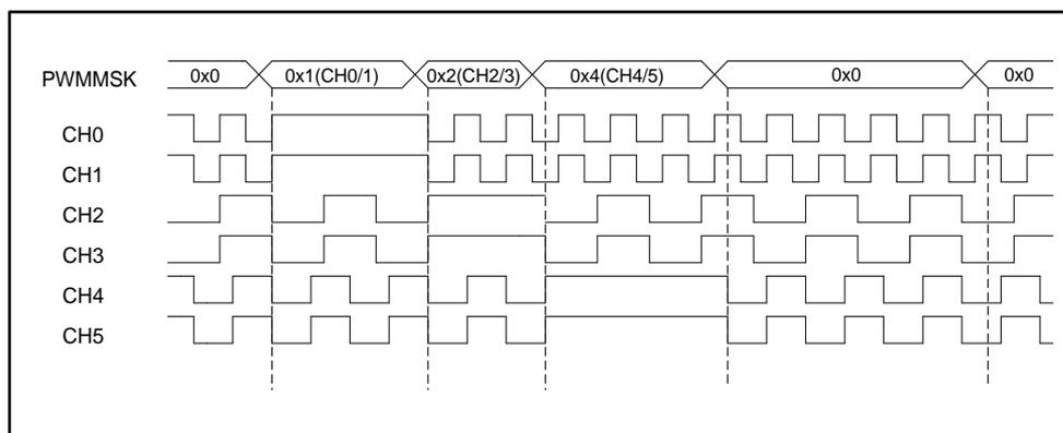
图 6-47 输出屏蔽功能示意图
