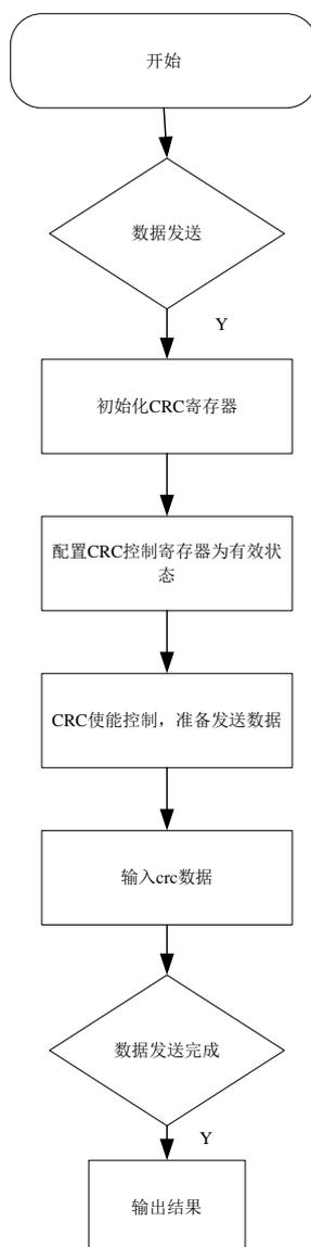
图 6-56 CRC 操作流程图
