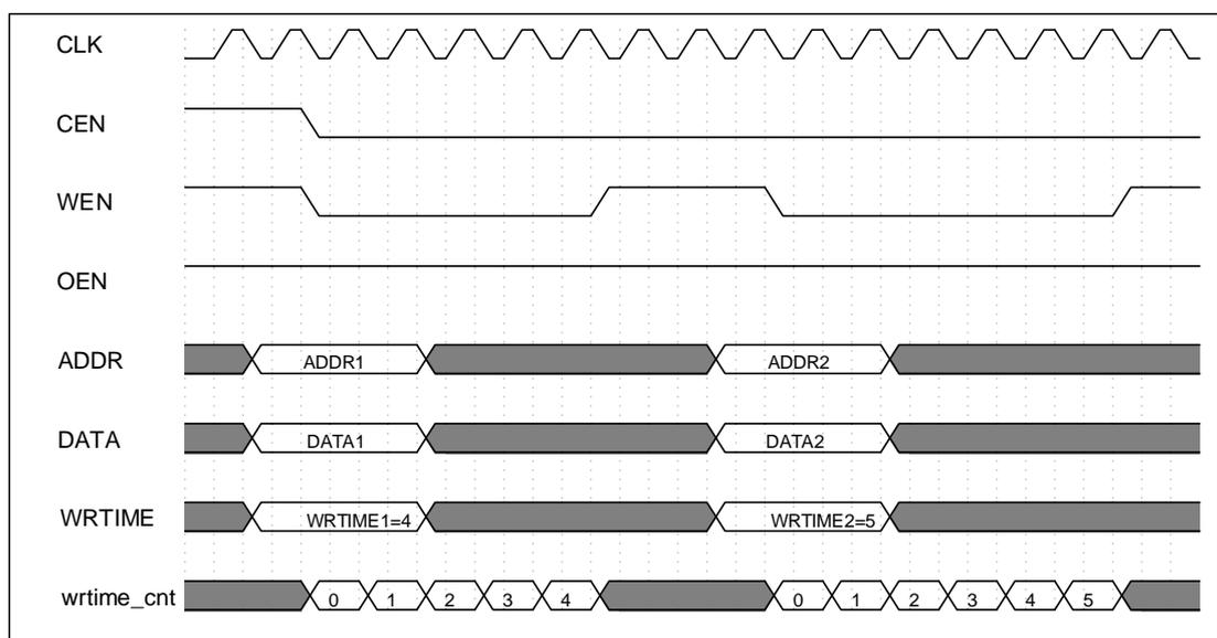
图 6-65 NORFLC 写操作时序图
