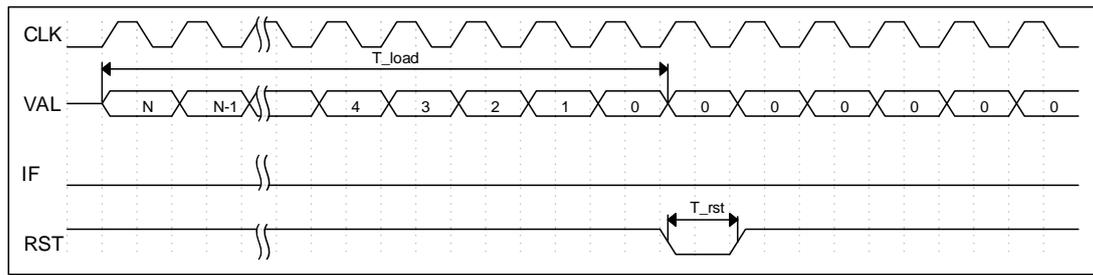
图 6-15 WDT 配置为 reset 模式波形图
