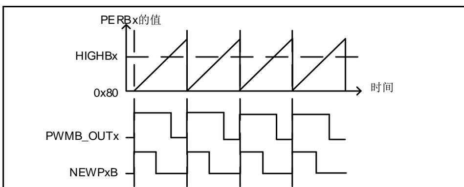
图 6-44 PWM 独立模式下新周期起始中断示意图
