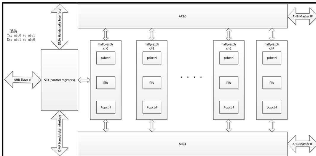
图 6-51 DMA 模块结构图
