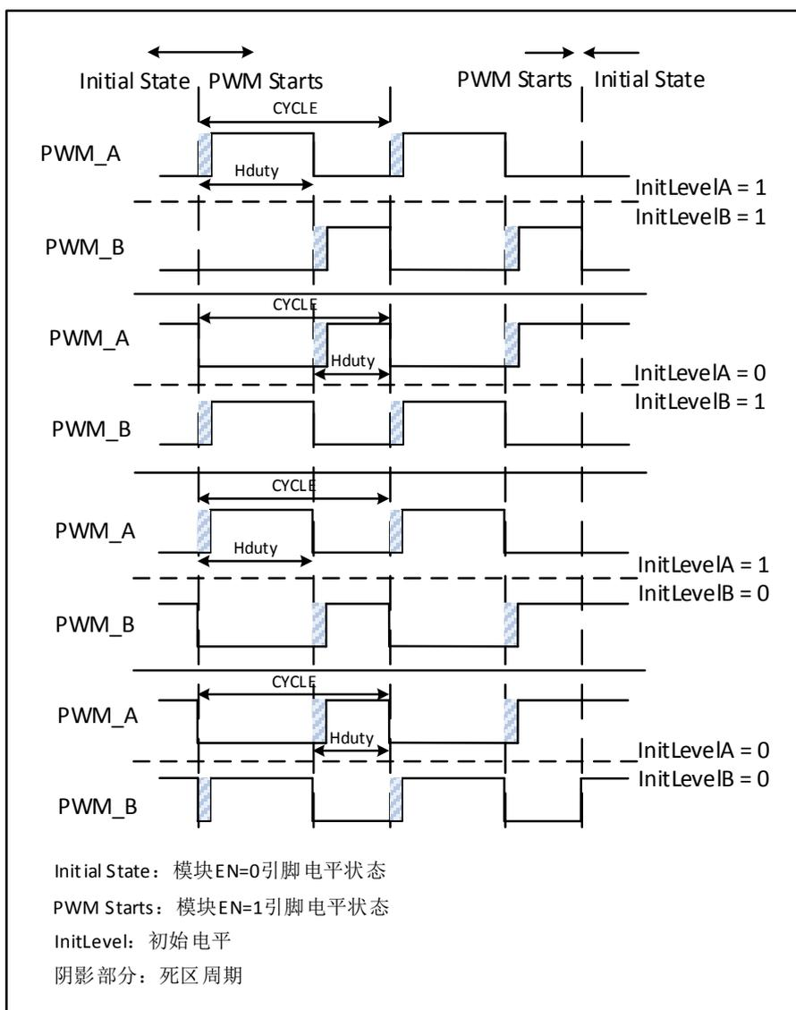
图 6-34 互补模式下初始电平设置示意图
