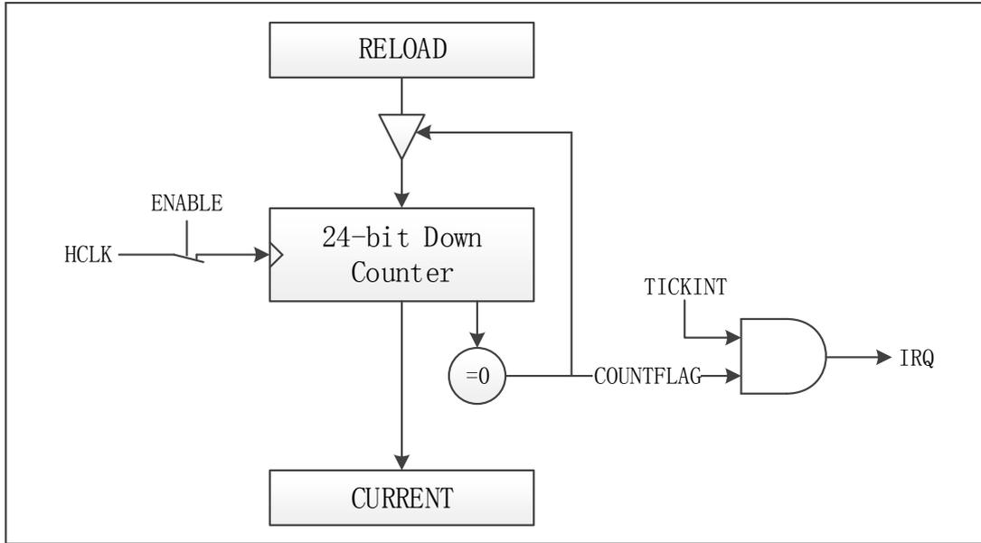
图 6-1 SYSTIC 模块结构框图
