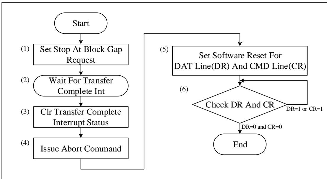
图 6-71 SDIO 同步中止传输示意图
