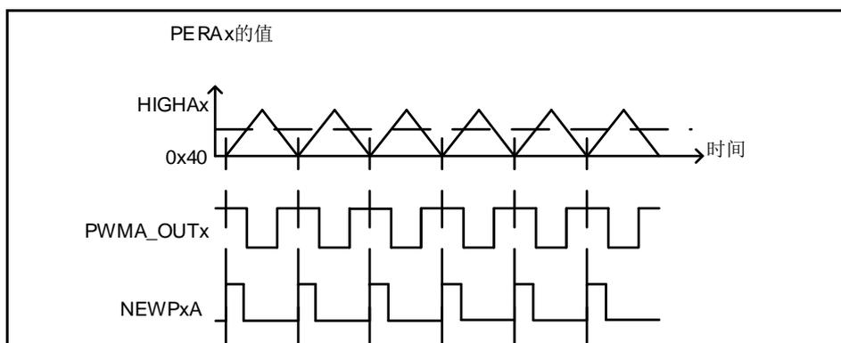
图 6-45 PWM 中心对称模式下新周期起始中断示意图
