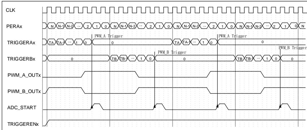
图 6-49 触发 ADC 采样示意图
