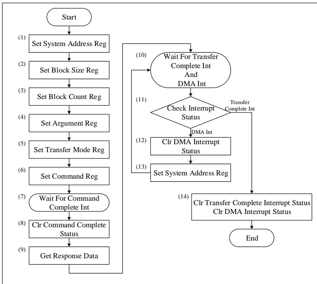
图 6-69 SDIO 使用 DMA 传输示意图
