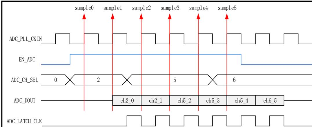
图 6-50 SAR ADC 多通道连续采样示意图
