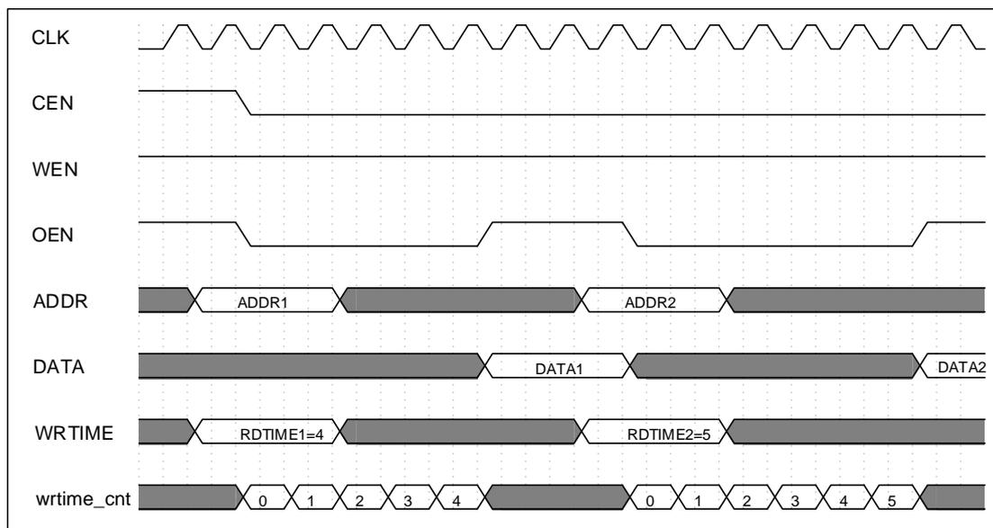
图 6-64 NORFLC 读操作时序图
