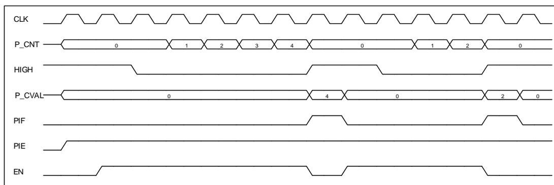
图 6-12 单次捕捉低电平脉冲
