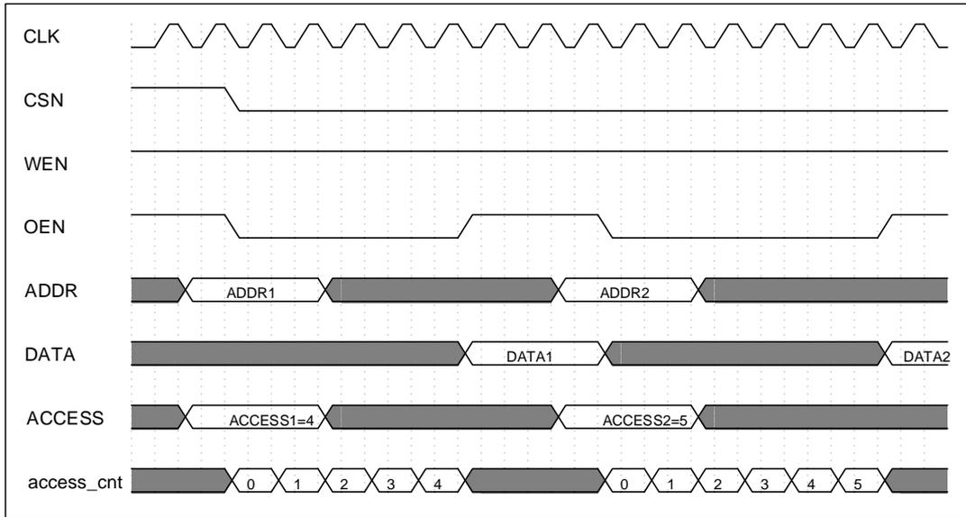
图 6-60 SRAMC 读操作时序图
