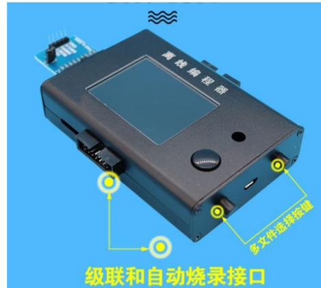
**USB 接口：**Micro USB 线用于和 PC 进行通信，也可独立供电。USB 供电的时候不能选择对外供电 5V。
