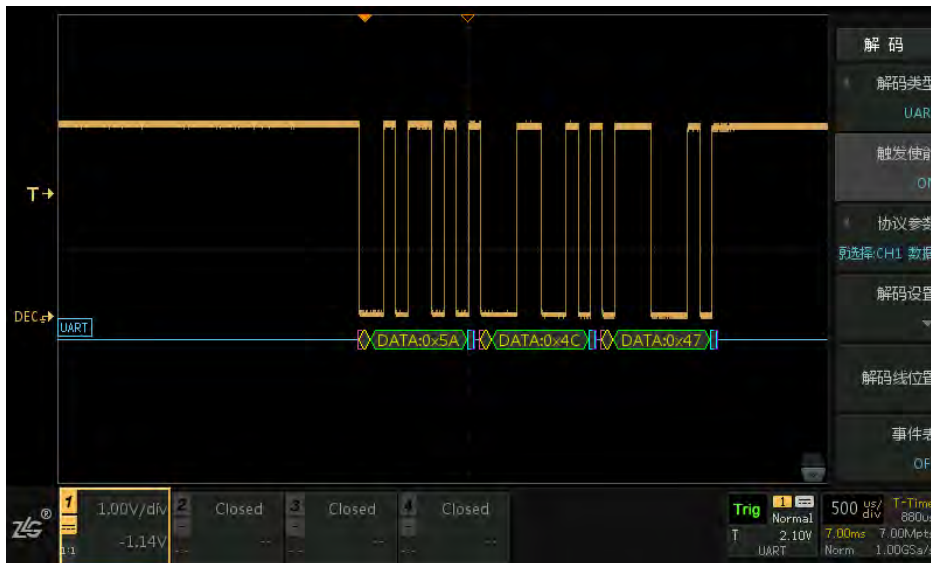
图 14.25 ZDS1000 系列示波器的 UART 信号
